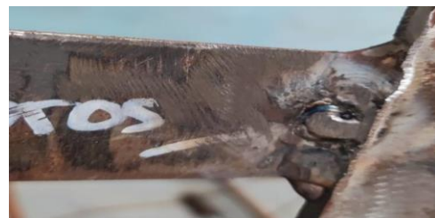
Gambar 7. Gambar Porositas (Sumber: Data diolah 2025)
